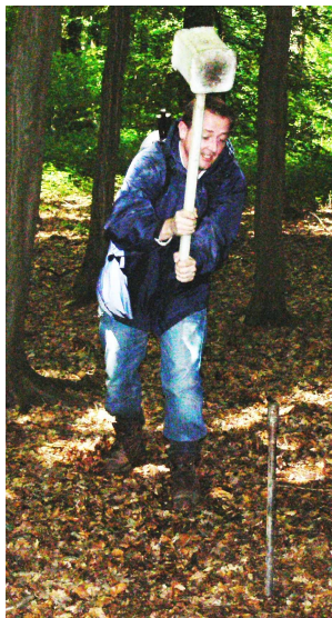
Abbildung 1: Einschlagen eines Bohrstocks, Foto: S. Kachurovskiy
